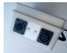
Trasformatore a 2 uscite. Dual power transformer.
